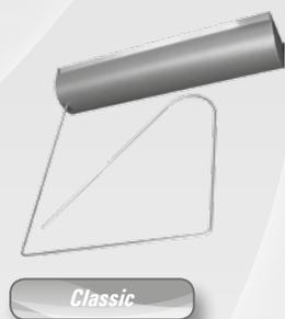
Abdeckschutzsystem für Saunaöfen mit Abschaltautomatik bei Druckbelastung. Wird die Abschaltwippe durch einen Gegenstand herunter gedrückt, wird der Heizvorgang unterbrochen bzw. fängt nicht an. Wird der Gegenstand entfernt, kehrt die Abschaltwippe in die ursprüngliche Position und der Betrieb wird fortgesetzt.
