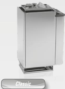
Saunaheizgerät mit eingebauter Steuerung. Für kleine Saunen 3 - 5 m<sup>3</sup>. Thermostatische Temperaturregelung 40 - 110 °C. Heizzeitbegrenzung bis 4 Std.
