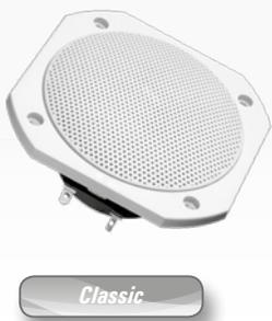
Einbau-Lautsprecher für Sauna und Dampfbadkabinen, 25 W Nennleistung / 8 Ohm, Ø 10 cm (4"), Glasfasermembran, 120°C temperaturfest, für außen geeignet, seewasserfest, IP65 Schutzklasse, Abdeckrahmen weiß.
