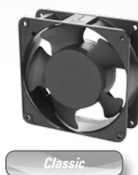
Lüftungsventilator, optimal für Saunanlagen bis 16 m<sup>3</sup> IP55 Schutzklasse, Umwälzleistung: 160 cbm/h, kugellagengelagert. Für größere Kabinen sind weitere Ventilatoren parallel geschaltet in die Abluftanlage lt. Saunabau-Richtlinien einzubauen. Zulässige Umgebungstemp.: -10 bis +70 °C.
