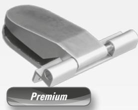
Selbstschließende Glastür-Türbänder - Zungenform, mit Anschraubband im Türfalz für innenliegende Türen für private und gewerbliche Anlagen, Bohrungen 2 x 20 mm, Tragkraft: 30 kg/Stück, Maße BHT: 130 x 125 x 35 mm
