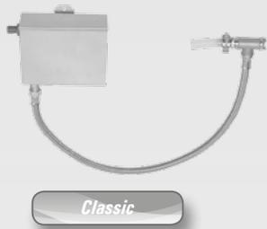
FWA 01 Compact Gerät für automatische Befüllung des Verdampfers aus dem Wasserleitungsnetz. Für EOS Bi-O Saunaöfen. Montage entweder direkt am Saunaofen bzw. an der Saunawand möglich. Verbindung mit Wasseranschluss mittels beigefügtem Stahl-Flexschlauch. Schlauchanschluss 1/2". Sehr kompakte, platzsparende Bauform. Kein Elektroanschluss notwendig.
