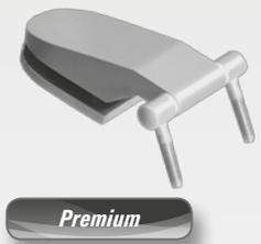
Zungenform für private und gewerbliche Anlagen. Befestigung im Falz: 2 Einbohr-Gewindestifte M8x40 DIN links/rechts für innenliegende Türen, Bohrungen 2x 20 mm (Maßblatt auf Anforderung), Tragkraft: 30 kg/Stück
