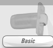
Rollenschnäpper mit höhenverstellbarer Schließrolle, Gehäuse und Rolle aus glasfaserverstärktem Polyamid - geeignet für Dauertemperaturen von 120 °C, alle anderen Teile aus nicht rostendem Edelstahl, für Holztüren 2 Stk., bei Glastüren/Fenster 1 Stk., pro Tür erforderlich.
