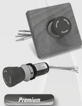
Spezial Not-Aus Taster für Saunaanlagen. Mit zwei getrennten Schaltkreisen (1 x geschlossen, 1 x offen). Extra langes Gehäuse für bequeme Installation, mit Schraubbefestigung. Durch zwei Schaltkreise können beim Betätigen zwei Aktionen ausgelöst werden (z.B. Saunaofen aus und Warnmeldung).
